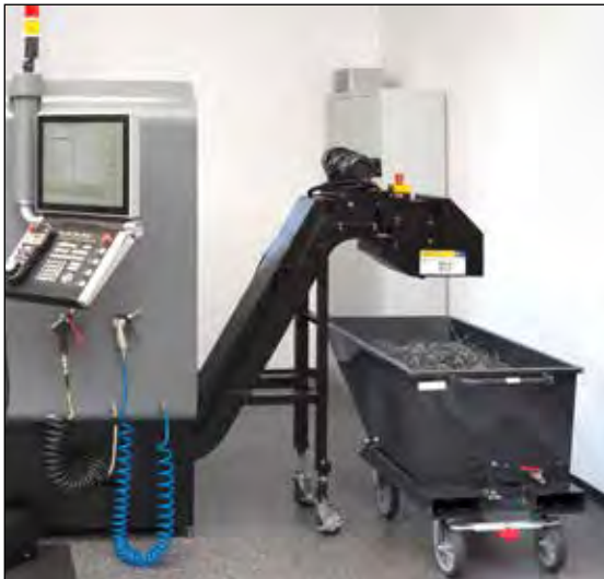
Anwendungsbeispiel: Muldenkipper als Spänebehälter
